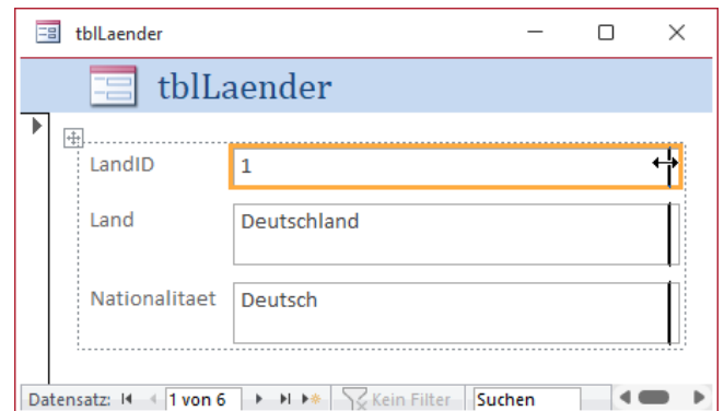
Bild 4: Anpassen von Steuerelementen in der Layoutansicht
